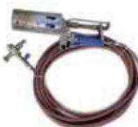
Καυστήρας παραγωγής ρεύματος θερμού αέρα που λειτουργεί με προπάνιο. Κατάλληλος για χρήση σε περιοχές με περιορισμούς στη χρήση ακάλυπτης φλόγας.
