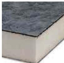
Θερμομονωτικό πάνελ από διογκωμένη πολυουρεθάνη συνδεδεμένη με ασφαλτικό φύλλο υάλου στην πάνω όψη και κορεσμένο φύλλο υάλου στην κάτω.
