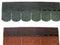
Ασφαλτικό κεραμίδι "καναδικού τύπου" που ανταποκρίνεται στα ευρωπαϊκά πρότυπα. Αποτελείται από έναν οπλισμό με φύλλο υάλου εμποτισμένο σε οξειδωμένη άσφαλτο και φέρει επένδυση από χρωματισμένα κεραμοποιημένα βασαλτικά σωματίδια στην άνω όψη. Διατίθεται σε ορθογώνιο σχήμα με πλάκες τριών στοιχείων και σε ουρά κάστορα με πλάκες έξι στοιχείων. Η παραγωγή και η διαδικασία ελέγχου έχουν πιστοποιηθεί κατά το πρότυπο UNI EN ISO 9001: 2008.
