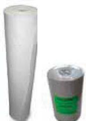
Μη υφαντό ύφασμα από λευκές ίνες πολυεστέρα, συμπιεσμένο και λαμιναρισμένο των 60 gr/m<sup>2</sup> που χρησιμοποιείται ως οπλισμός επενδύσεων με υγρές μεμβράνες στεγανοποίησης όπως Acriplast και Idroplast, με μεμβράνες για ζαρντινιέρες, με την ακρυλική μεμβράνη Polysint και την ινοπλισμένη επένδυση Polyfibrex.
