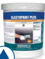
Θιξοτροπική ασφαλτική πάστα αδιαβροχοποίησης σε υδατικό διάλυμα με σφαιρίδια πολυστυρένιου και κόκκους καουτούλου. Σύστημα ιδιαίτερα ενδεδειγμένο για εξωτερική αδιαβροχοποίηση θεμέλιων, υπόγειων κελαριών και γκαράζ, φέρουσας τοιχοποιίας, εξωτερική αδιαβροχοποίηση δεξαμενών, δοχείων και φρεστών, προστατεύοντας το σκυρόδεμα από τη διάβρωση του νερού.
