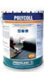
Ασφαλτική κόλλα διαλύτη, ιδιάίτερα κατάλληλη για ψυχρή συγκόλληση ελαστομερών μεμβρανών πολυμερισμένης ασφάλτου (εωτερικό τελείωμα με άμμο ή πούδρα) σε επιπέδες επιφάνειες (μέγιστη κλίση 10%). Χρησιμοποιείται σε νέες διαστρωματώσεις, για επισκευή παλαιών επικαλύψεων και συγκόλληση μεμβρανών σε υποστρώματα από σκυρόδεμα ή ξύλο, αντικαθιστώντας την κλασική θερμοκόλληση.
